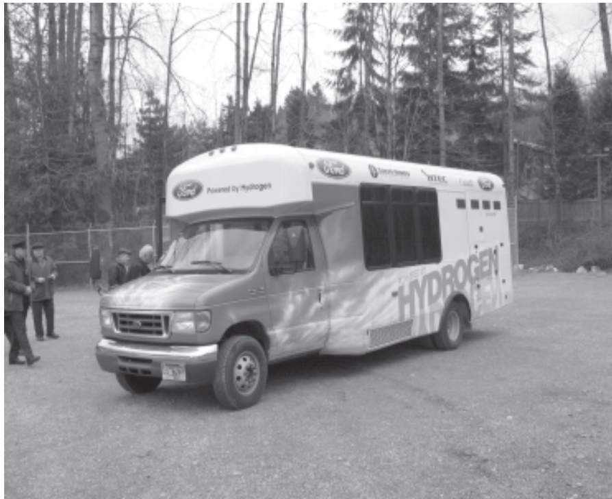
ნახ. 3.2. „მწვანე“ ავტომობილი (მიკროავტობუსი), შიდაწვის ძრავით, საწვავი - წყალბადი
