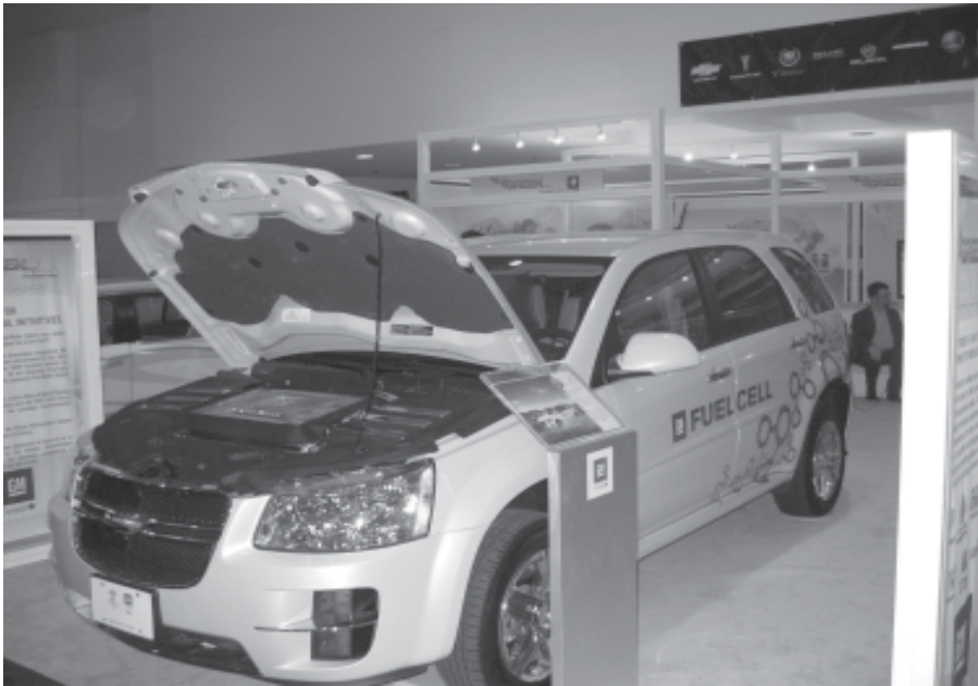
ნახ. 3.3. „მწვანე“ ავტომობილი, ელექტრომობილი საწვავ-ელემენტით, საწვავი - წყალბადი
